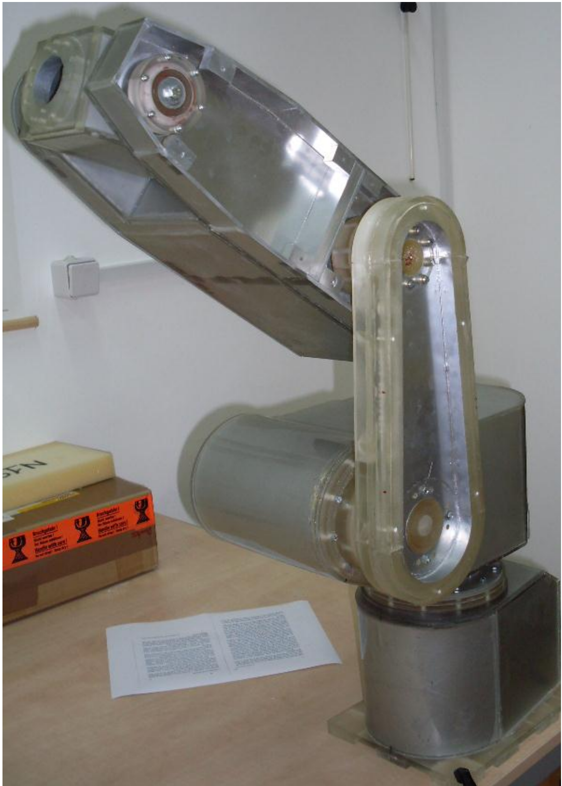
Fig. 7 Robot Fanuc realizat din rășină epoxidică – ansamblu fără capacele brațelor 1 și 2
