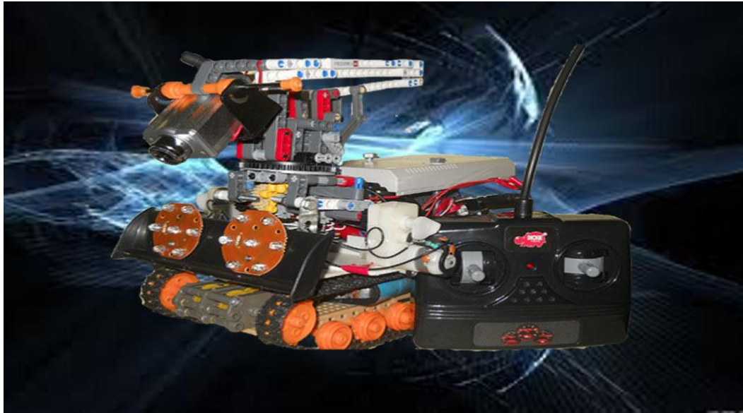
Fig. 10 Prototipul funcțional al minirobotului pe șenile Robo Geniu
